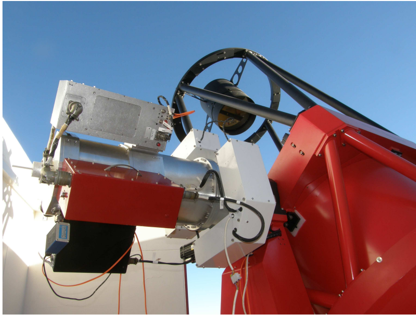
Abbildung 3.1: Das IRIS-Teleskop. Links im Bild die Infrarotkamera am Nasmyth Fokus.
